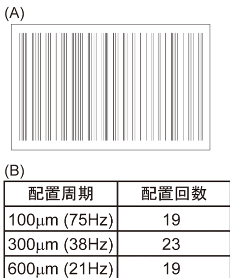
図12 ランダム配置した凸構造サンプル (A) 試作したサンプルのイメージ (B) 配置周期とその割合
